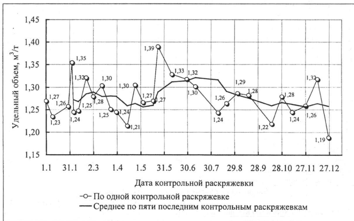
Рис. 5.13 – Удельный объем хлыстов по контрольным раскряжевкам Усть-Илимский ЛПК. Поставщик - Катинский леспромхоз. 1990 год. Среднее значение удельного объема - 1,28 м 3 /т, стандартное отклонение - 0,043 м 3 /т, коэффициент вариации - 3,4 %
