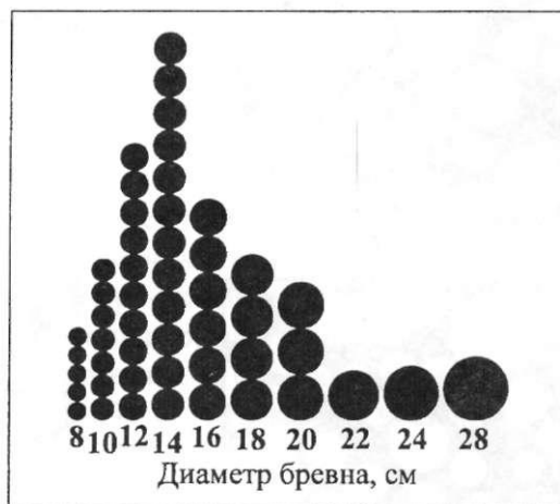
Рис. 5.6 – Распределение моделей бревен по диаметрам, принятое при графическом моделировании (рис. 5.7)
