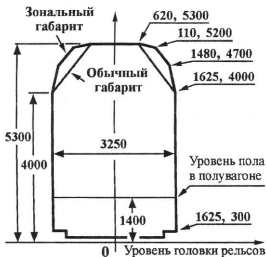
Рис. 1.2 - Габариты погрузки вагонов Координаты точек перегиба габарита и размеры, мм
