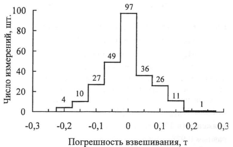
Рис. 5.11 – Распределение погрешности взвешивания лесоматериалов на автомобильных весах. Усть-Илимский ЛПК
