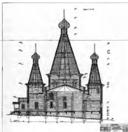
Ил. 11. Троицкая церковь. Продольный разрез. Проект реставрации. 2005. Архив ООО «КАРЭНСИ»
