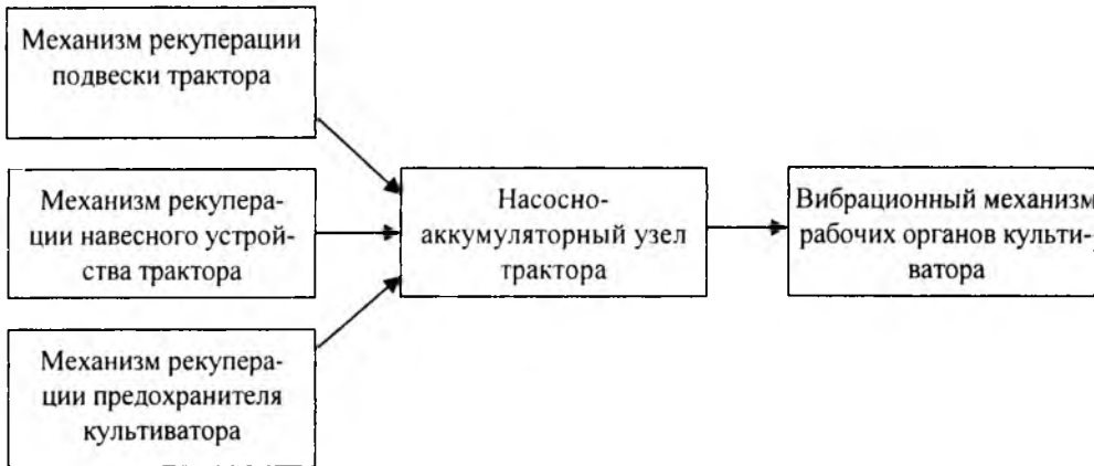
Рис. 1. Структурная схема системы рекуперации энергии лесного почвообрабатывающего агрегата в составе трактора и дискового культиватора
