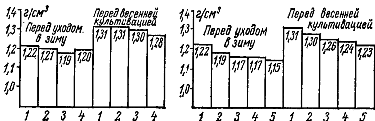
Рис. 13. Влияние полупаровой обработки почвы, выполненной культиватором и боронами после вспашки, на объемную массу почвы (г/см 3 ) в слое 0—20 см (почва суглинистая, колхоз им. Заслонова Толочинского района Витебской области, среднее за 1976—1979 гг.):
