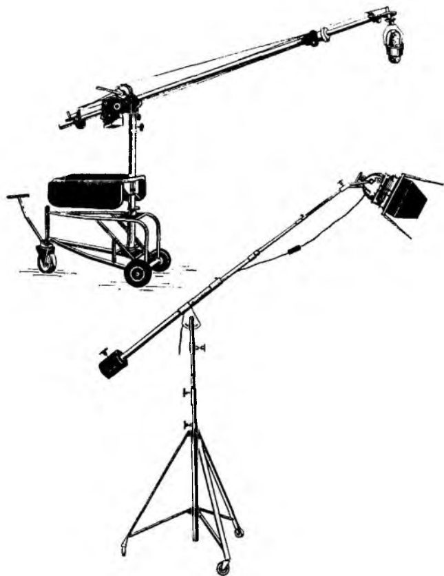
Рис. 34. Осветительный прибор на передвижном консольном штативе
