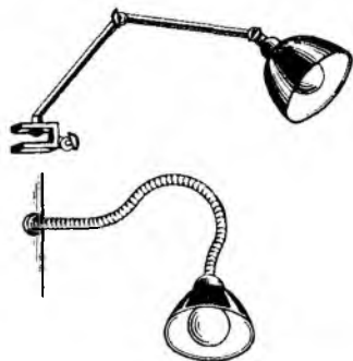
Рис. 36. Примеры светильников консольного крепления
