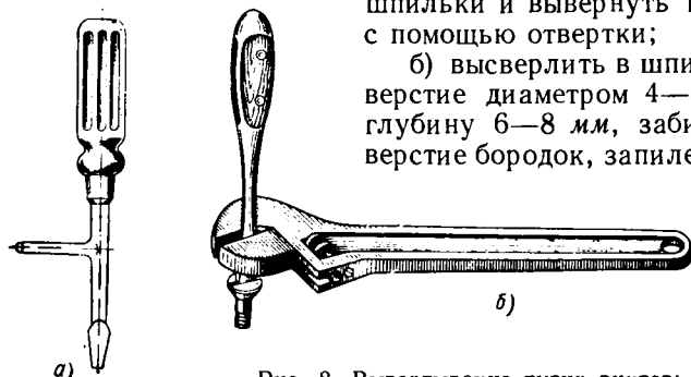
Рис. 8. Вывертывание тугих винтов:
