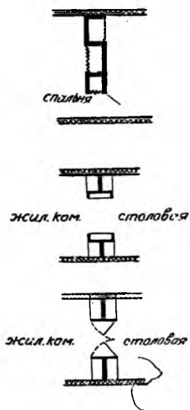
Рис. 7. Расположение шкафов в смежных комнатах
