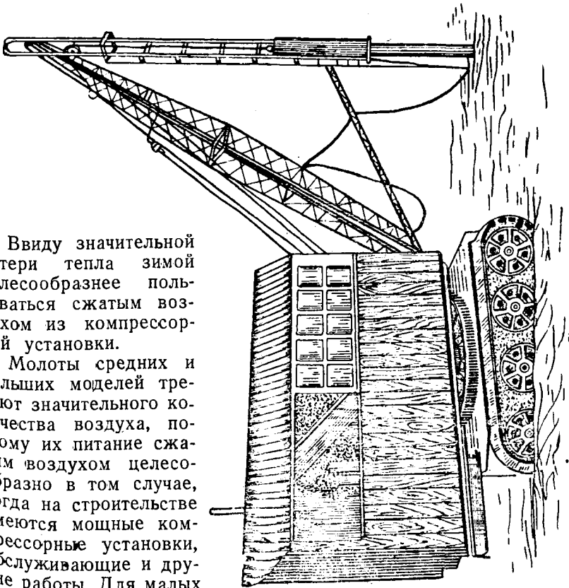
Фиг. 100. Подвесные рамки к стрелам кранов для работ с молотами двойного действия
