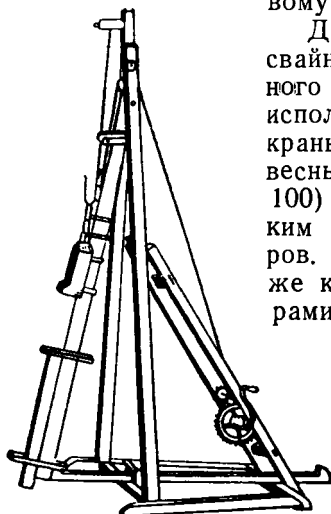
Фиг. 99. Копры для забивки наклонных свай
