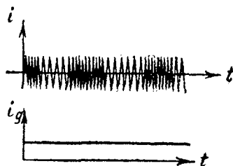
Рис. 66. Действие линейного детектора на частотно-модулированные колебания.
