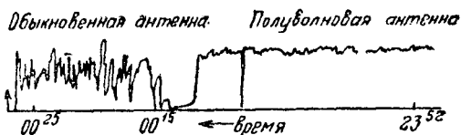
Рис. 55. Сравнение кривых изменения силы приёма во времени от обыкновенной и полуволновой антенн.
