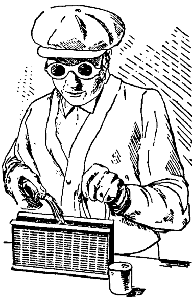
Фиг. 63. Пайка радиаторной секции при помощи газовой горелки (февки)
