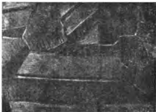
Фиг. 5. Структура латуни Л62 после прокатки и отжига при 700^{\circ} (ув. 200)
