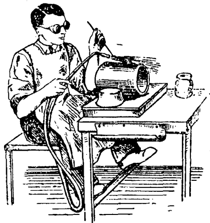
Фиг. 62. Пайка серебряным припоем при помощи газовой горелки
