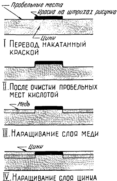
Рис. 81. Схема электролитического способа «глубокого» офсета
