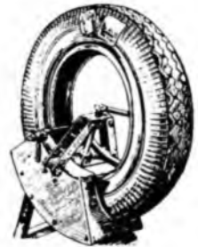
Рис. 331. Вулканизация в мульде.
