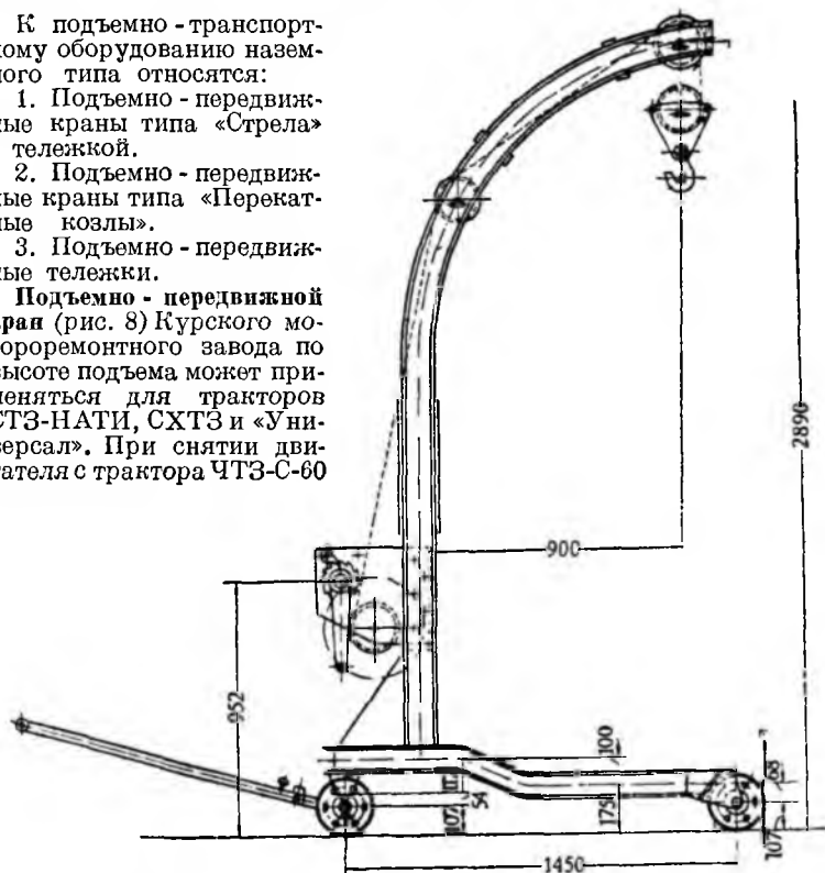
Рис. 8. Схема общего вида подъемно-передвижного крана Курского мотороремонтного завода.
