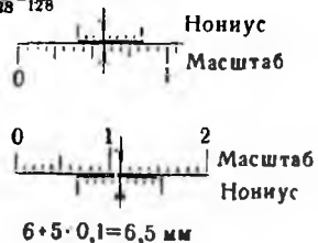
Рис. 218. Нулевая установка штангенциркуля и нониуса.
