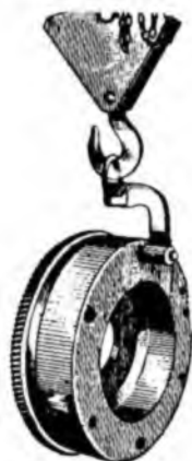
Рис. 24. Схватка для маховиков ЧТЗ.
