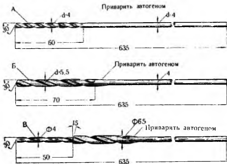
Рис. 100. Шарошка и сверла для развальцовки и высверливания трубок сердцевины радиаторов:
