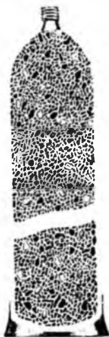
Рис. 303. Ацетиленовый баллон с пористой массой.
