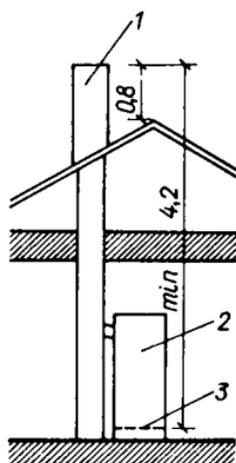
Рис. 24. Наименьшая высота трубы отопительного оборудования на твердом топливе и в случае скатной крыши
