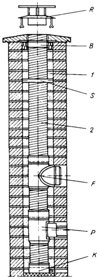
Рис. 31. Элементы нержавеющей труб системы „Вэстерформ-Х“ и „Иноксид“
