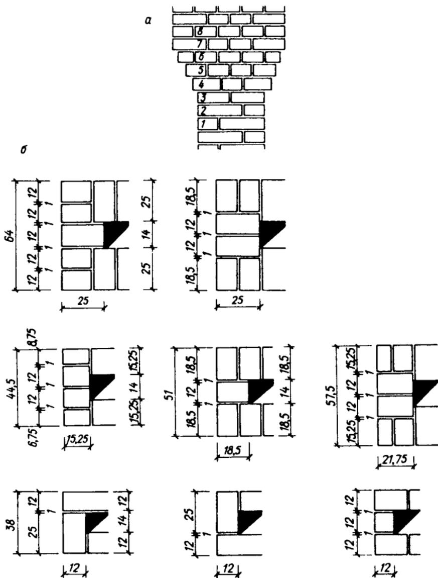
Рис. 4. Перевязка швов кирпичной кладки капители трубы
