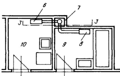
Рис. 18. Принципиальная схема проекта установки отдельно стоящей изолированной металлической трубы в односемейном доме со скатной крышей, подсоединение к трубе газовых отопительных устройств 1 — очистной элемент типа „Р”; 2 — подсоединительные элементы типа „Т”; 3 — зонтик трубы типа „Е”; 4 — защитный конус; 5 — трубчатая гильза; 6 — газовый отопитель; 7 — обмуровка; 8 — газовый водонагреватель; 9 — ванная; 10 — прачечная
