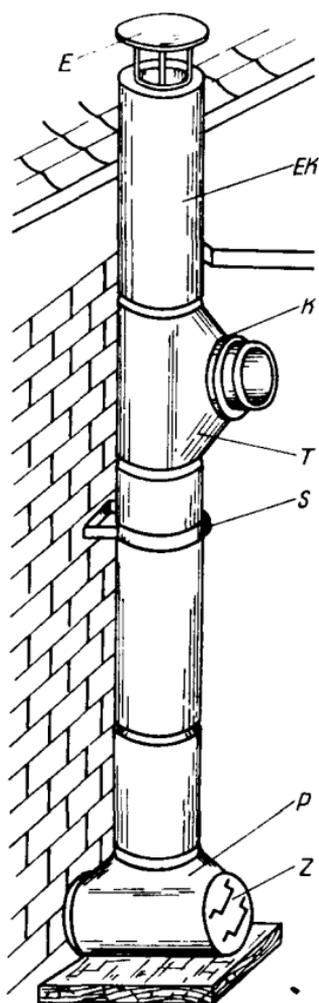
Рис. 17. Общий вид смонтированной теплоизолированной (алюминиевой, стальной) печной трубы
