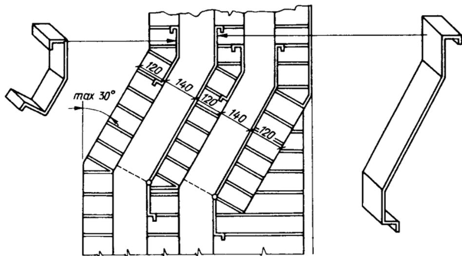
Рис. 28. Конфигурация правостороннего отнoса трубы и устройство металлической облицовки, см
