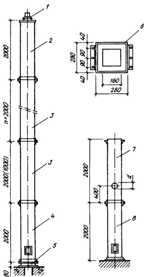
**Рис. 20. Элементы теплоизолированной металлической чердачной трубы**
