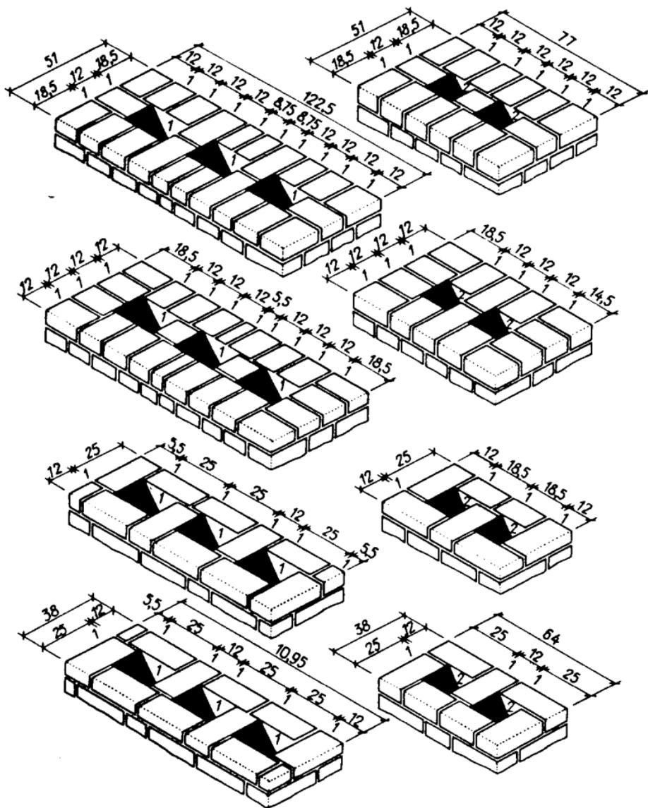
Рис. 5. Перевязка швов кирпичной кладки трубы с двумя и тремя дымоходами четырехугольного сечения (внутри здания)
