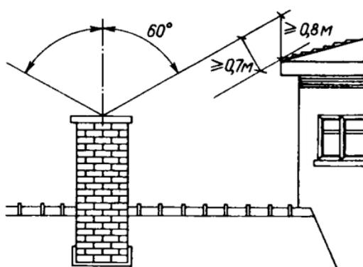
Рис. 25. Размеры „конуса трубы“
