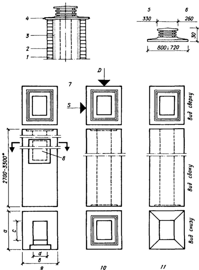
Рис. 22. Элементы бетонных труб
