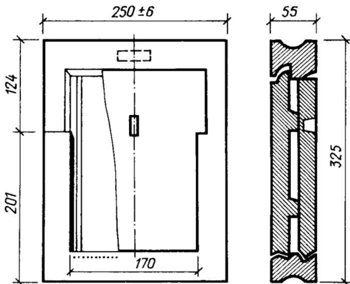
Рис. 15. Крышки очистного отверстия
