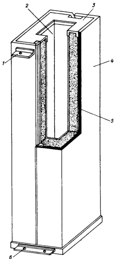
**Рис. 19. Конструкция стенок теплоизолированной металлической чердачной трубы**
