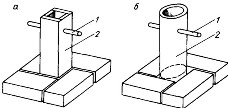
Рис. 6. Шаблоны для выкладки дымоходов
