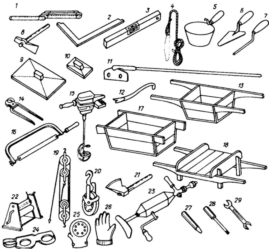
Рис. 23. Инструменты, применяемые при строительстве труб
