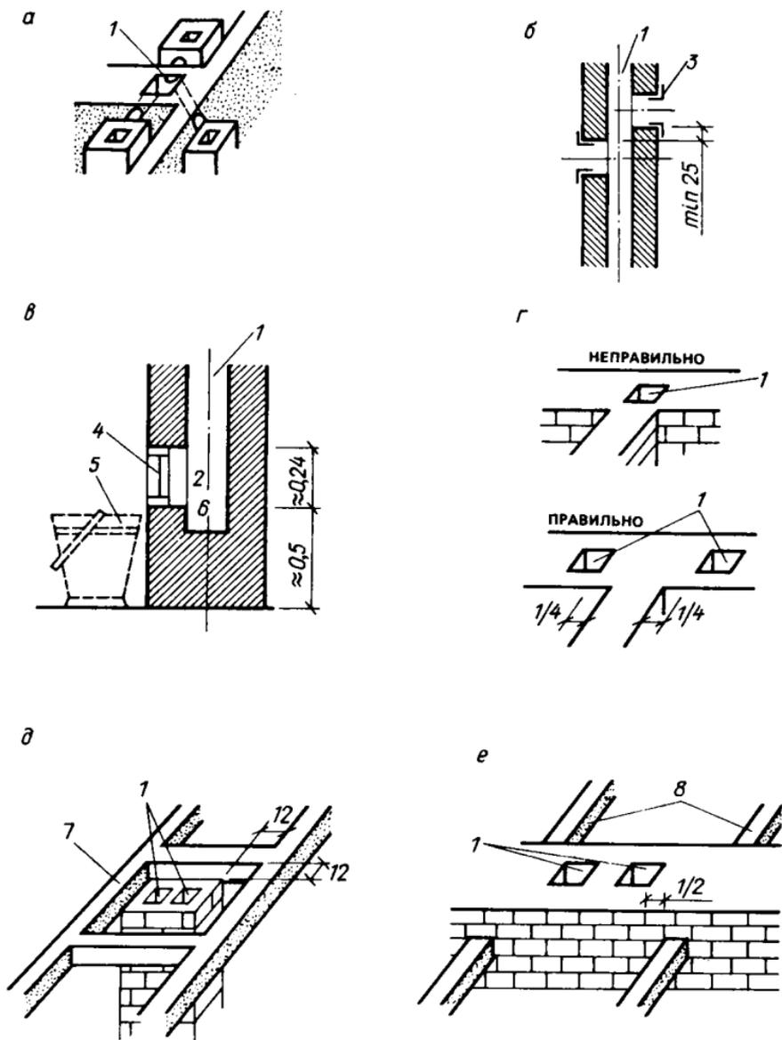
**Рис. 26. Правила устройства дымоходов и подсоединений отопительных устройств (размеры в см)**
