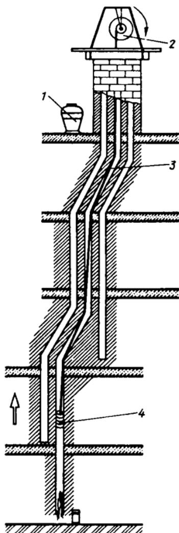
Рис. 30. Оштукатуривание дымохода
