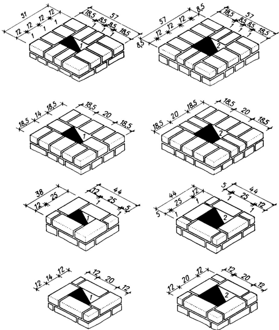
**Рис. 3. Перевязка швов кирпичной кладки трубы в случае прямоугольного сечения дымохода**
