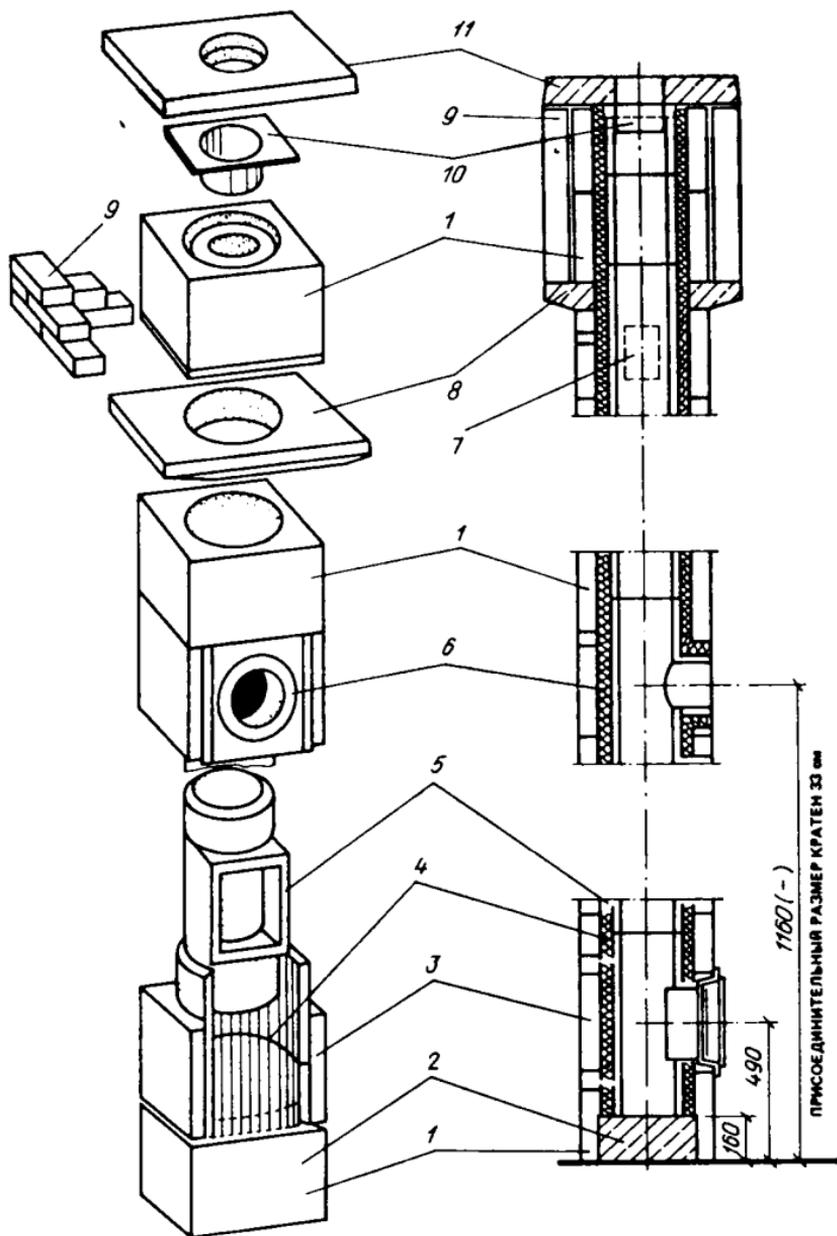
Рис. 16. Порядок монтажа элементов трубы системы Шиделя
