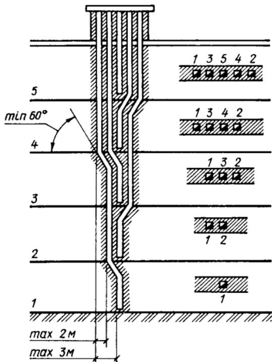
Рис. 27. Допустимые размеры отнoса дымоходов (пример конфигурации трубы с одинаковым расположением отопительных устройств на каждом этаже)
