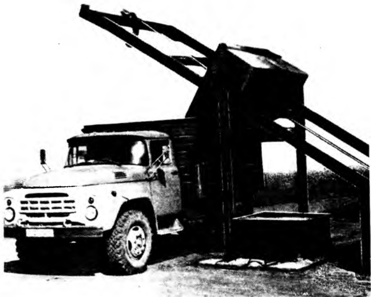
Р и с. 2. Выгрузка помета из бункера-накопителя ковшем в кузов самосвала
