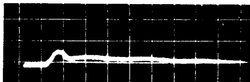
Рис. 7. Волна напряжения при срезе без восстановления напряжения: + О—П U = 250 кВ/дел.; t = 5 мкс/дел.
